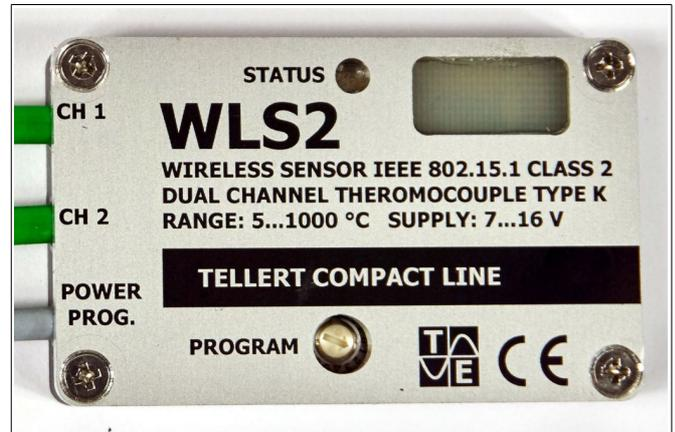
Abbildung 2: Drahtlose Slave-Einheit WLS2.
