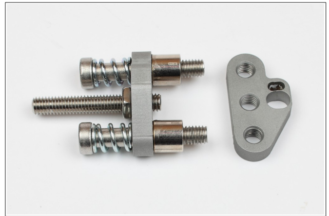
Abbildung 25: Dann werden die Federn auf die Schrauben geschoben.
