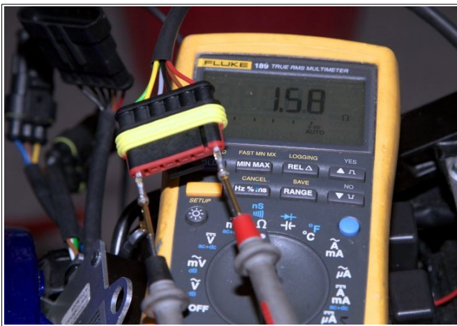
Abbildung 10: Messen des Spulenwiderstandes.
