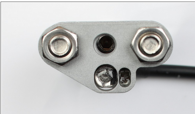
Abbildung 30: Hierbei ist zu beachten, dass das schwarze Hallsensorelement dem Magneten gegenüberliegt. Das Hallsensorelement ist das schwarze Teil in der vernickelten Sensorhülse. Der Magnet ist in der Magnetplatte eingeklebt.
