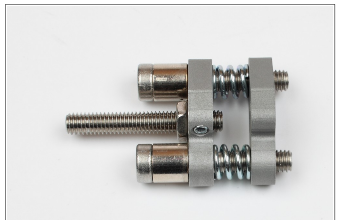
Abbildung 21: Anschließend werden die Kontermuttern gelöst und entfernt (SW10).
