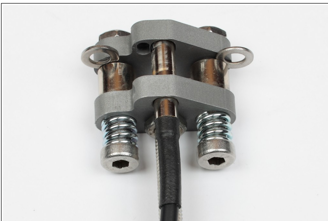
Abbildung 29: Anschließend wird der Hallsensor (zum Einstellen der Mindestkraft) justiert, wobei der Sensor mit etwa 1 mm vorgespannt sein sollte. Beim Erreichen der Mindestkraft leuchtet die Force (bzw. Start ) LED der CTS-Box auf.
